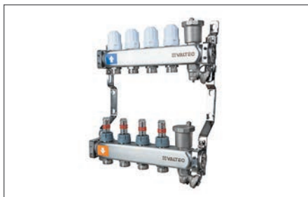
VTc.579.EMNX коллекторный блок из нержавеющей стали AISI 304 с расходомерами, термостатическими клапанами, автоматическими воздухоотводчиками и дренажными клапанами (от 3 до 12 выходов)
