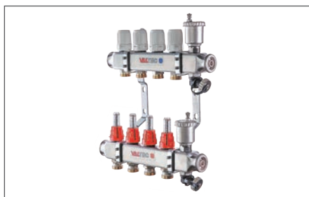
VTc.586.EMNX коллекторный блок из нержавеющей стали AISI 304 с расходомерами, балансировочными клапанами, автоматическими воздухоотводчиками и дренажными клапанами (от 2 до 12 выходов)
