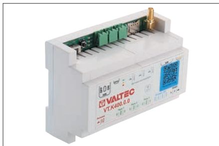
VT.K400 Универсальный контроллер для смесительных узлов
