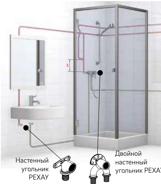
Рис. 06-4 Подключение смесительной арматуры для водопроводов горячей воды с постоянным протоком - Пример: подключение сверху
