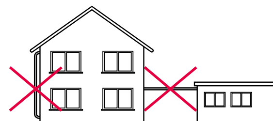
Рис. 37-7 Прокладка на открытом воздухе не допустима
