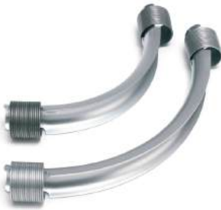
Рис. 34 Фиксаторы поворота (водоснабжение) (4 x ø) – 90° и фиксаторы поворота (водоснабжение / отопление) (5 x ø) – 90° для изгиба труб ø32
