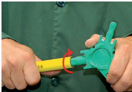
CALIBRATION / CALIBRATURA / KALIBRIERUNG / COUPER
