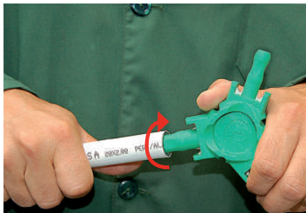
CALIBRATION / CALIBRATURA / KALIBRIERUNG UND ENTGRATEN S / COUPER
