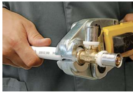
PRESSING / PRESSATURA / VERPRESSUNG / PRESSER
