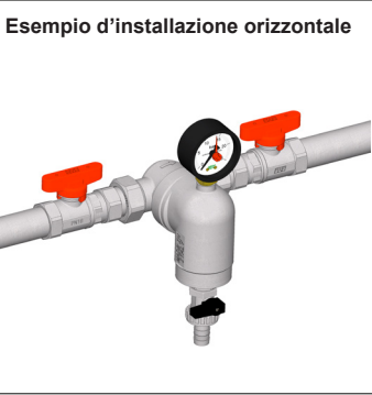
Esempio d'installazione orizzontale
