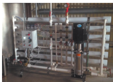
Обратноосмотическая система производительностью 3 м³/ч для производственной линии соков
