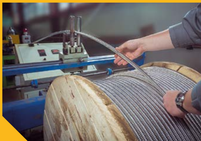
Подача гофрированной трубы Stahlmann для отжига
