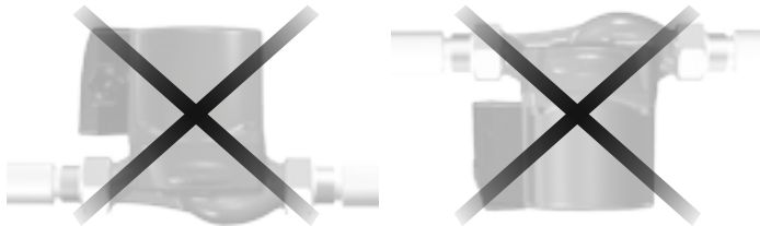
Рис. 2 Недопустимое расположение вала насоса
