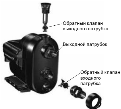
Рис. 23 Обратные клапаны входного и выходного патрубков
